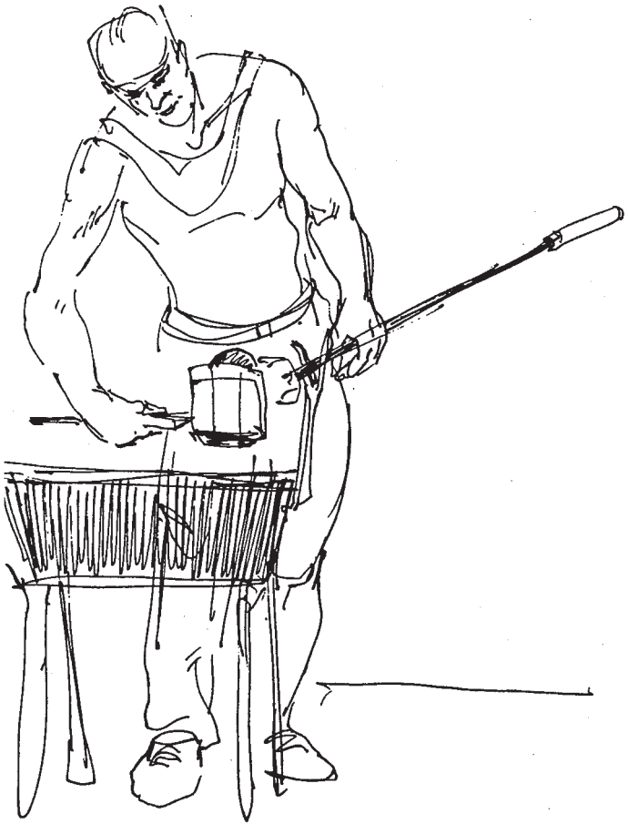
Der Einbläser beim Formen des Glases mit dem Wulgerholz.
