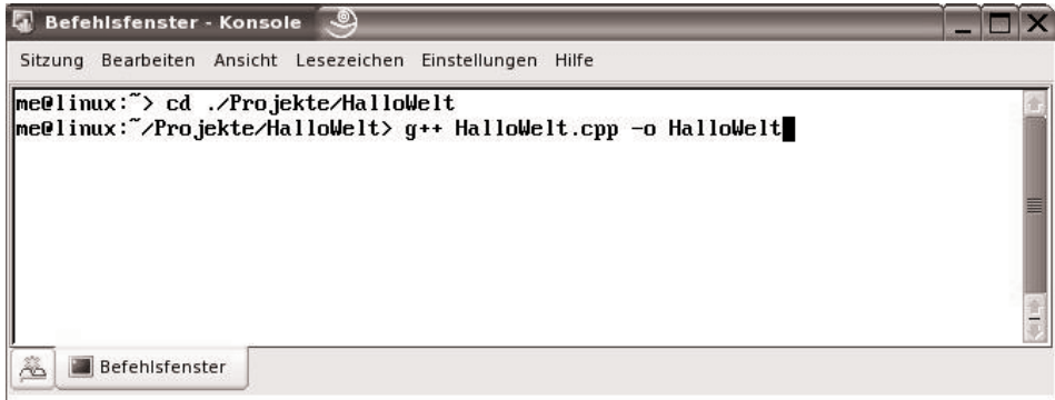
Bild 2.8 Kompilation und Erstellung einer ausführbaren Datei
