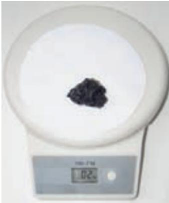
**Bild 3a:** Waage mit noch unverbranntem Glanzruß (2 Gramm)
