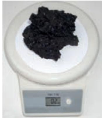
**Bild 3b:** Waage mit verbranntem Glanzruß (2 Gramm)
