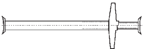
Bild 1.3 Leichte Kanalstrebe für den waagerechten Grabenverbau
