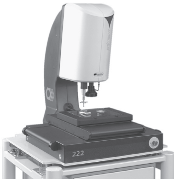
Basierend auf optischem KMG in Tischbauweise (a)
