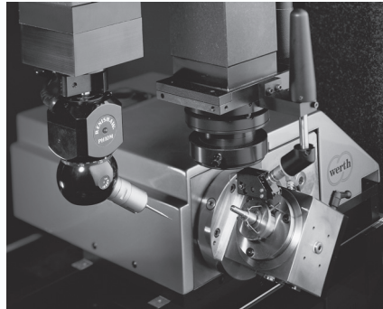
Basierend auf optischem KMG mit Granitportal und zusätzlicher Dreh- und Schwenkchse (b)
