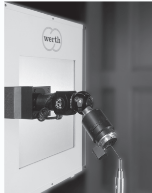
Basierend auf optischem KMG mit Granitportal und zusätzlicher Dreh- und Schwenkchse (b)
