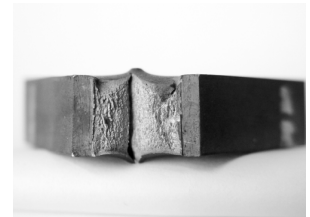
Bruchbild Hochlage: Verformungsbruch
