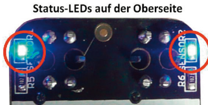
Bild 7.3 Die Status-LEDs des Line-Finders
