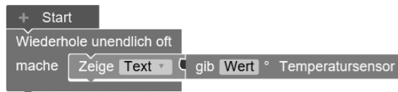
Bild 4.20 Thermometer mit dem Calliope mini
