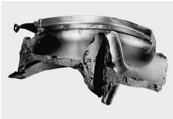
Abb. 1.9 Größeres Bruchstück eines Axialverdichterrades. Korrosionsspuren auf der Innenseite des Wuchtringes. Scheibendurchmesser 130 mm.
