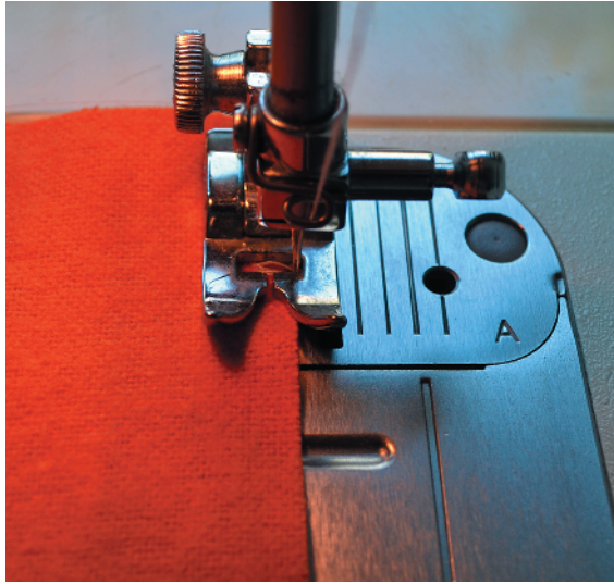
Abbildung 1.5: Der Nähfuß fixiert den Stoff auf der Stichplatte. Die Schraube links hält den Nähfuß fest und die Schraube rechts die Nähadel.
