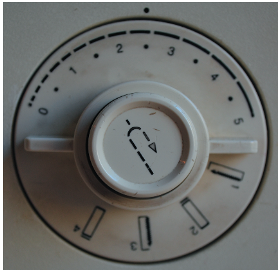
Abbildung 1.7: Die Stichtlänge wird an der Oberseite des Rades in Millimetern angegeben; unten sind die Arbeitsgänge der Knopflochautomatik zu erkennen und in der Mitte die Rückwärtstaste.
