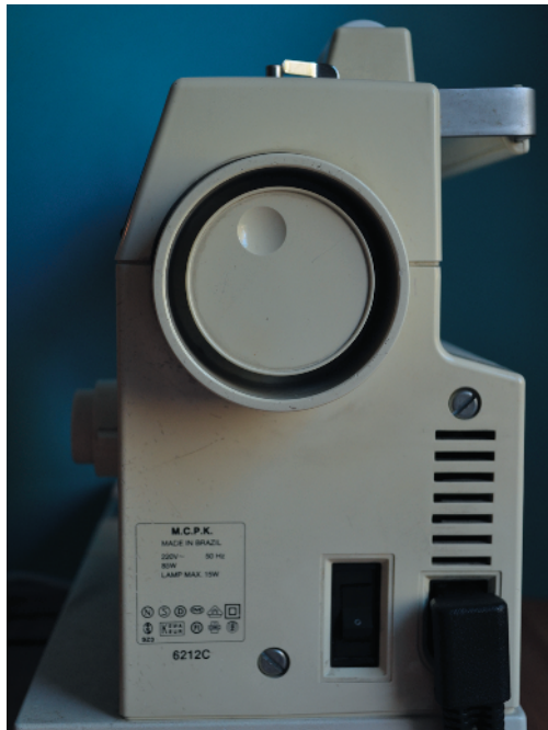
Abbildung 1.4: Auf dem Handrad befindet sich die Taste zum Aufwickeln der Spule als Mulde. Rechts neben dem Betriebsschalter befindet sich der Stecker vom Fußhebel und Stromanschluss.
