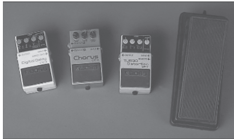
Abbildung 1.3: Vier übliche, von Gitarristen oft benutzte, elektronische Effekte (von links nach rechts): Delay, Chorus, Verzerrer, Wah-Wah
