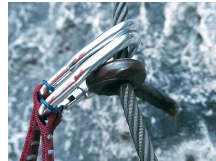
Zwei Klettersteigkarabiner (oben) sind immer sicherer als nur einer (unten)
