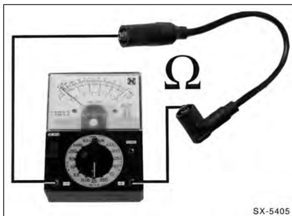
Das Ohmmeter wird an die 2 Anschlüsse eines Verbrauchers oder an die 2 Enden einer elektrischen Leitung angeschlossen. Dabei spielt es keine Rolle, welches Kabel (+/-) des Meßgerätes an welchen Kontakt angeklemmt wird. Ausnahme: Widerstandsmessungen an Bauteilen, die Dioden enthalten. Um eine Diode auf Durchgang zu prüfen, muß sie in Durchlaßrichtung an das Ohmmeter angeschlossen werden.
