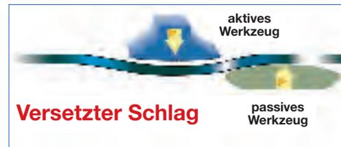
**3. Versetzter Schlag:** Eine Verdichtung oder Stauchung des Blechs erreicht man durch das seitlich versetzte Schlagen mit einem hinter das Blech gehaltenen Faustkeil. Das passive Gerät ist nur dafür da, das Blech seitlich zu unterstützen. Man nennt dies Tiefzieh-Prozess.
