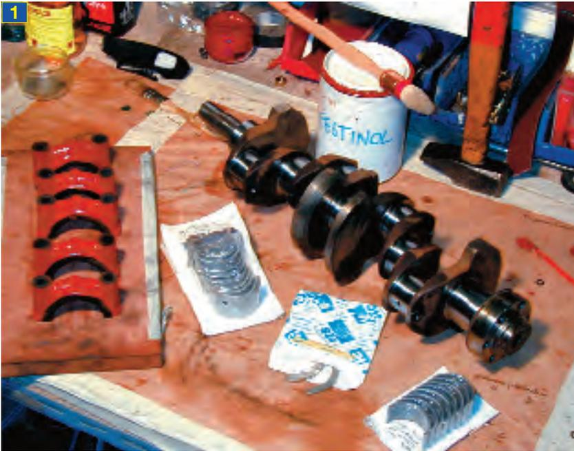
**1** Hier ist alles zu sehen, was wir brauchen: eine gereinigte und gerichtete Kurbelwelle, die Kurbelwellenlagerdeckel, gesäubert und lackiert, die Kurbelwellen-Hauptlagerschalen und die Abstandshalter für das Seitenspiel. Die Pleuellagerschalen rechts im Bild sind für den nächsten Arbeitsgang bestimmt. Das Demonstrationsobjekt für den Kurbelleneinbau ist hier ein Zylinderblock „Rush super“ des Simca Aronde P60 von 1961.
