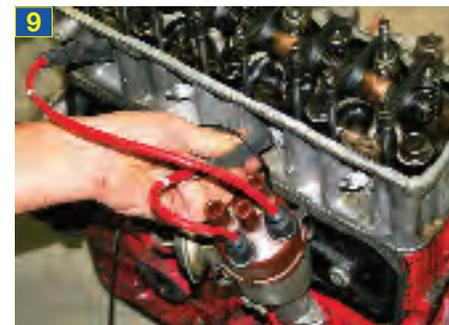
folge der Kontakte in der Verteilerkappe und kann die Zündkabel an die zugehörigen Zündkerzen anschließen: Kontakt 3 folgt auf 1, also Kabel von Kontakt 3 an Kerze 3 usw.
