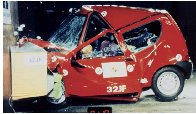
In Crashtests wird untersucht, wie Kräfte Autos verformen und wie sie auf die Insassen wirken.
