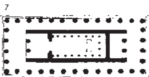
Athen, Hephaisteion, 440 v. Chr. Klassischer dorischer Peripteros 6/13. 3-stufige Krepis, 3-schiffige Cella mit 2-geschossigen Säulen. Keine Achsenbindung der Anten.
