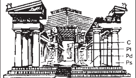
Zu 7: Dorischer Peripteros. System nach Ägina, Aphaia-Tempel, um 500 v. Chr. beg. C Cella durch 2 doppelgeschossige Säulenreihen in 3 Schiffe geteilt. Hier: durch Emporen in den Seitenschiffen entstehen »Galerien«. Ps Peristasis = Säulenkranz; Pt Pteron = Umgangshalle über dem Pd Peridromos = Bodenfläche des Umgangs.
