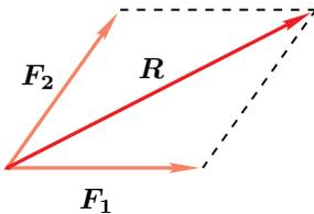
1.3.: Die Addition zweier Kräfte mit der Parallelogrammregel
