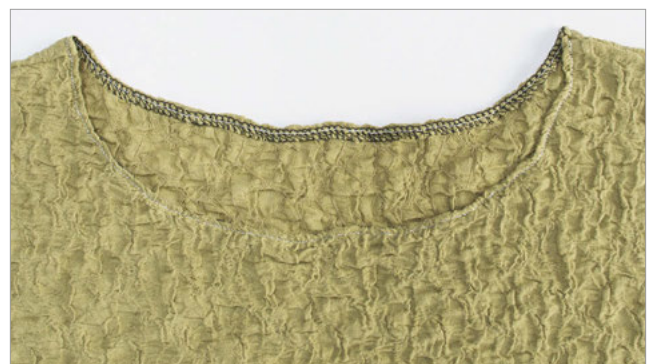
Außen- und Innenansicht einer umgeschlagenen und abgesteppten Naht am Halsausschnitt.
