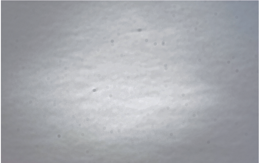
Abbildung 8: Sensorflecken – sichtbar gemacht mit verstärkten Kontrasteinstellungen am PC. Hier hilft nur noch eine Feuchtreinigung des Sensors.
