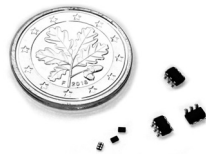
Abb. 1-4 8-Bit-Controller im Vergleich zu einer 1-Cent-Münze
