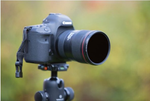
Objektiv mit aufgeschraubtem rundem ND-Filter
