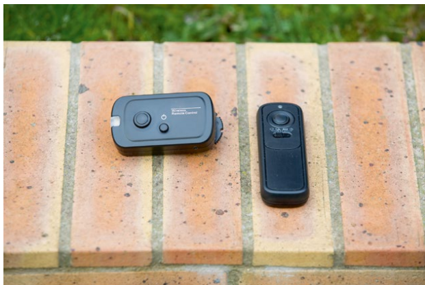
Funkfernauslöser mit Sender und Empfänger
