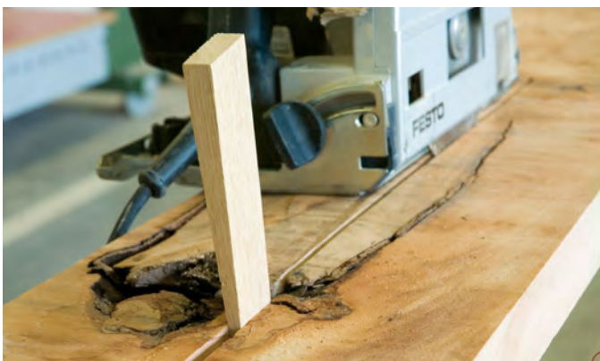
Ein Hartholzkeil, hinter dem Sägeblatt eingeschlagen, verhindert das befürchtete „Kneifen“ der Säge.
