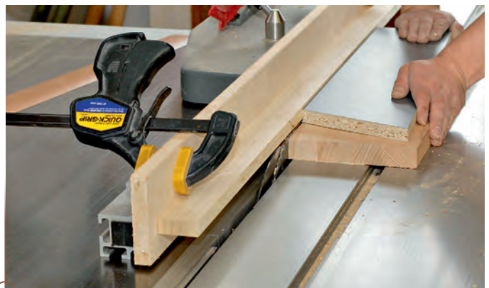
Unregelmäßige Werkstücke verlieren durch das Sägen mit Schablone und Hilfsanschlag ihren Schrecken.
