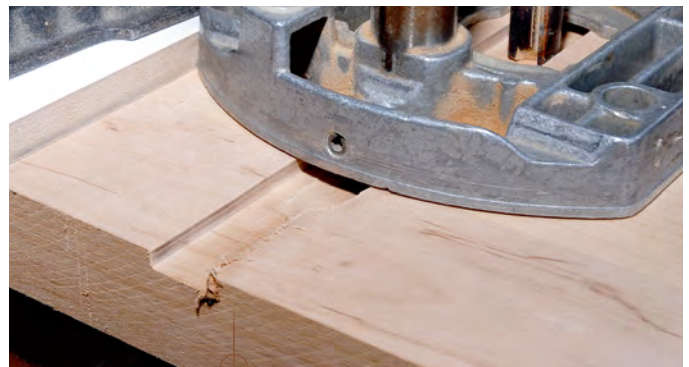
Ausrisse wie diese lassen sich vermeiden, wenn eine Nut in zwei Gängen gefräst wird.
