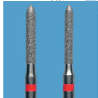
Abb. 4-40 Für das Finieren der Präparation sind torpedoförmige Diamantinstrumente besonders geeignet. Sie sollten in ihrem Durchmesser auf den gewünschten Substanzabtrag abgestimmt sein. Für presskeramische Veneers sind Instrumentendurchmesser von 1,2 und 1,4 mm sinnvoll einsetzbar, mit denen sich zervikale Schnitttiefen von 0,6 bzw. 0,7 mm realisieren lassen.
