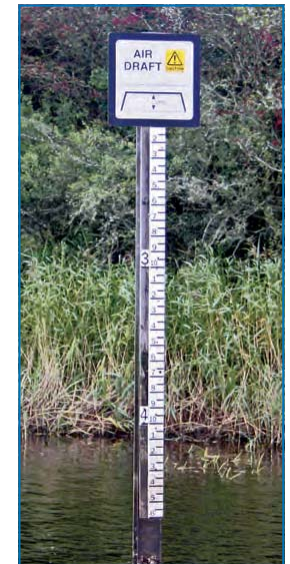
Da der Wasserstand des Shannon variiert, gibt es Anzeiger für die freie Durchfahrtshöhe vor Brücken.
