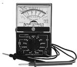
Legen Sie Spannung an X1 an. Messen Sie mit einem **Multimeter** (AC-Spannungsmessbereich) oder mit einem **Duspol** die Eingangsspannungen an X2, X3, K1, S1, S2 und E1. Tragen Sie Ihre Messwerte in Tabelle 44 ein und bewerten Sie die Ergebnisse.
