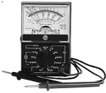
Ermitteln Sie mit einem **geeigneten Messgerät** den Durchgang der einzelnen Adern zwischen Stecker und Verteilung. Es darf hierbei **keine Spannung** an der Verteilung anliegen. Tragen Sie ggfs. Ihre Messwerte in Tabelle 41 ein und bewerten Sie die Ergebnisse.
