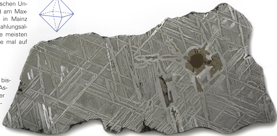
Bruchstücke sind zum einen Stein-Eisen-Meteorite (Pallasite) oder wie hier ein fast reiner Eisen-Meteorit (mit Ausnahme des bräunlichen Olivin-Einschlusses). Die verschiedenen Eisen-Nickel-Metalle weisen die namensgebende Oktaeder-Form auf.
